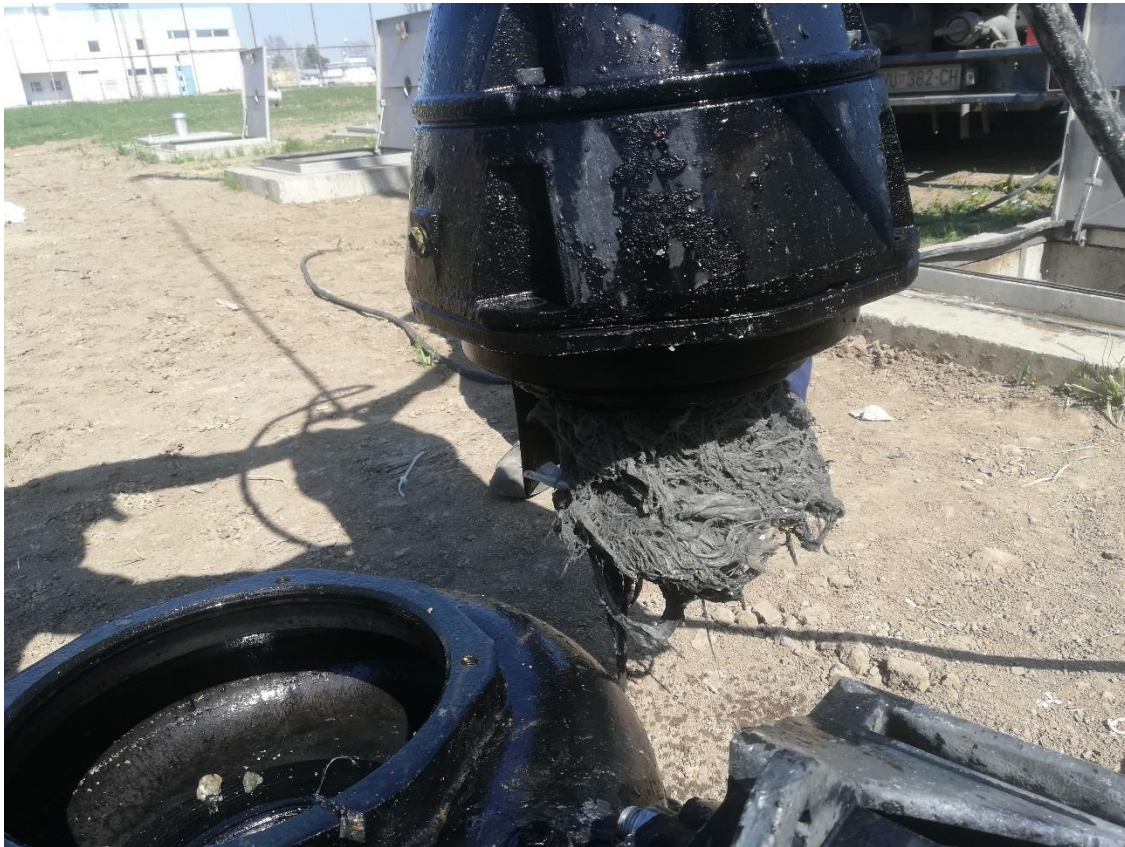
Slika 3. Obustava rada crpki uslijed uvlačenja vlažnih maramica
